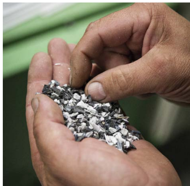
Spillet från produktionen mals ner och återvinns till nya plastplattor. – Men då får det inte se ut så här, då måste det vara absolut rent och bara en sort i taget, säger Peter och identifierar blixtnabbt de olika plastsorterna: – Här är ABS med ASA-yta, här ABS utan, här har du PVC och där är styren. Det här får gå till värmeåtervinning.
